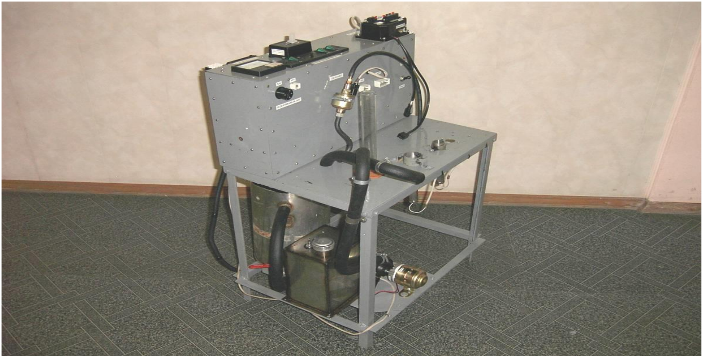
Рис. 13 – Стенд контроля подогревателя
